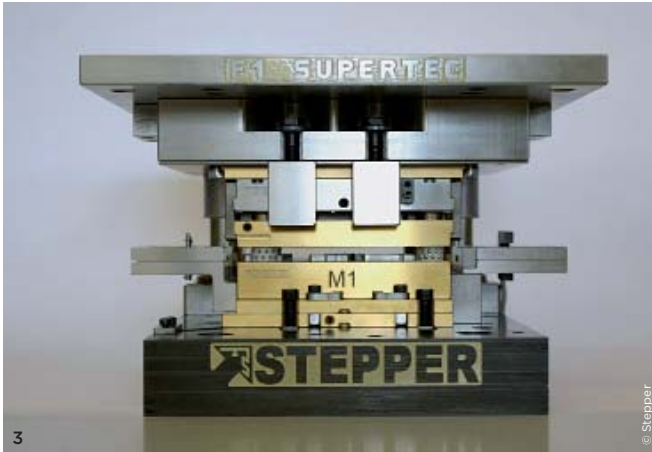
3 Stepper Stanzwerkzeug zur Fertigung von Kontaktteilen für die Automobilindustrie. Stepper fertigt damit bis zu sieben Steckverbindungen gleichzeitig; das ergibt 16.100 gefertigte Kontaktteile pro Minute.
